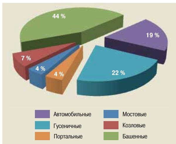
**Рис. 51.** Распределение аварий по типам грузоподъемных кранов
