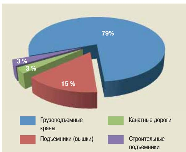
**Рис. 50.** Распределение аварий по видам подъемных сооружений
