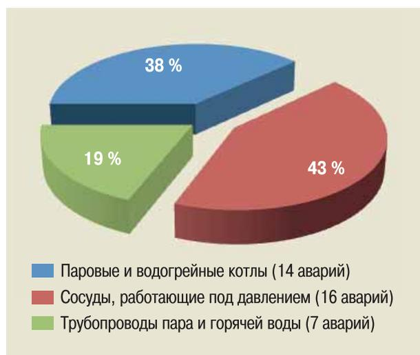
**Рис. 27.** Распределение аварий по типам технических устройств в 2005—2014 гг.
