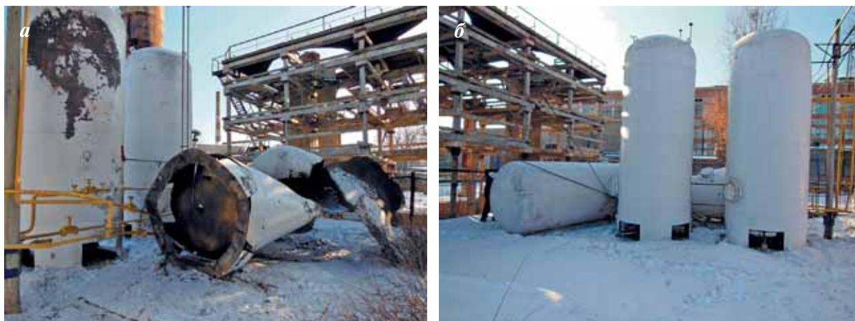
Рис. 32, а, б. Разрушения ресивера водорода в результате взрыва в ООО НПК «ДАЛЕКС»
