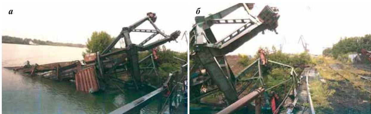
Рис. 55, а, б. Падение портального крана ПК-28 в р. Обь
