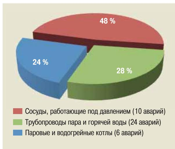
**Рис. 29.** Распределение аварий по типам технических устройств в 2010–2014 гг.
