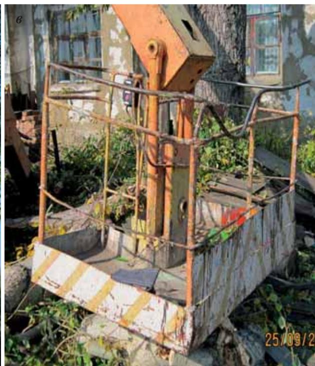
**Рис. 56, а, б, в.** Падение верхнего колена стрелы и люльки автогидроподъемника АГП-18 при производстве работ по опилковке деревьев в г. Богородицк Тульской области
