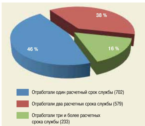
**Рис. 39.** Сведения об износе котлов большой энергетики (ТЭС, ТЭЦ, ГРЭС и т.д.) в 2013 г.
