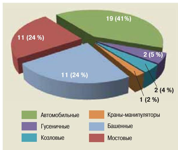
**Рис. 60.** Распределение несчастных случаев со смертельным исходом по типам грузоподъемных кранов (всего 50 ПС 53)
